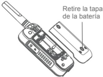
3. Cierre la batería y apriete los dos tornillos en el sentido de las agujas del reloj.
