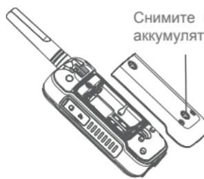
Снимите крышку аккумуляторного отсека.
